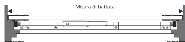
Diminuire il telo avvolgibile di 20 mm dalla misura di battuta
